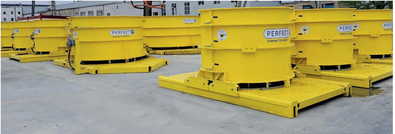
Концепция технологии Perfect Forming Technology используется для изготовления элементов с внутренним диаметром до 3000 мм
